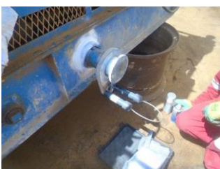
Test magnétoscopique. Test de ressuage.
