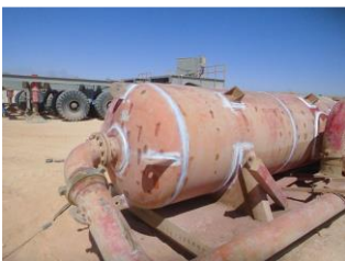
Épurateur de gaz.
