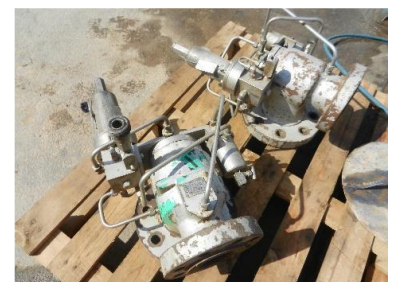
Réétalonnage des soupapes de sécurité.
