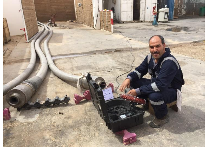
Inspection avec caméra pour un flexible HP.
