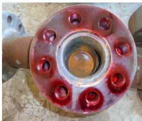
Test magnétoscopique. Test de ressuage.
