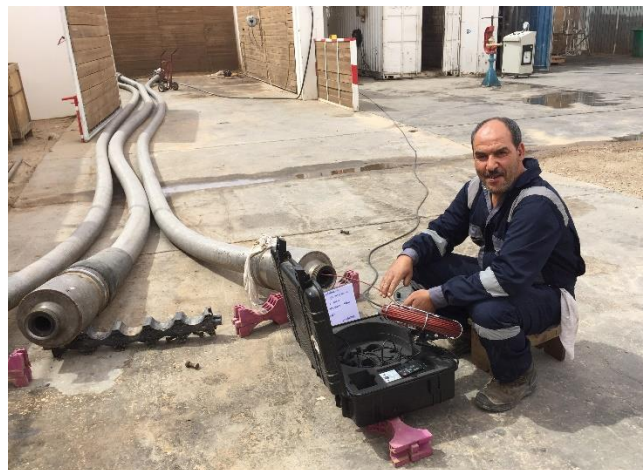
Inspection avec caméra pour un flexible HP.
