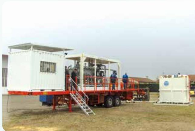
L'expertise acquise en équipement de process pour tests de puits permet à FCE de proposer des séparateurs de production biphasiques ou triphasiques au cas par cas.
