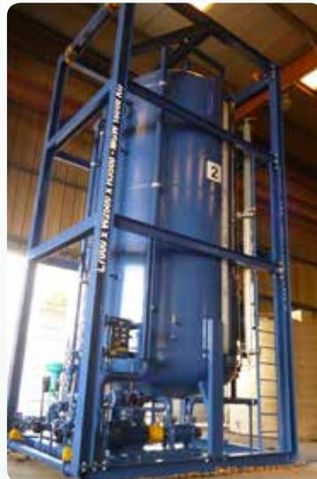
2 x 50 BBL, double compartiment, 250 PSI, avec pompe centrifuge intégrée
