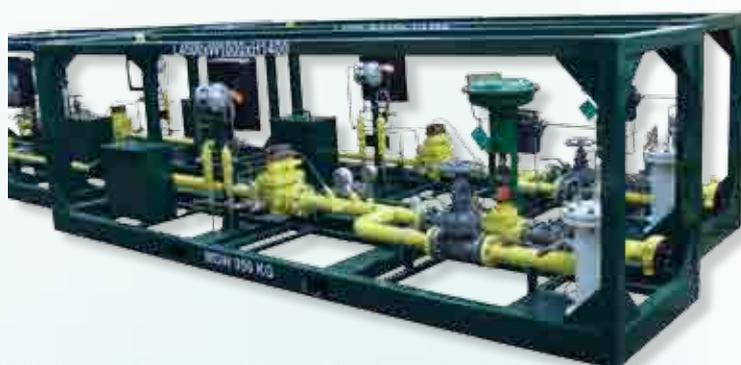
Skid de comptage gaz et de contrôle de pression 1440 PSI
