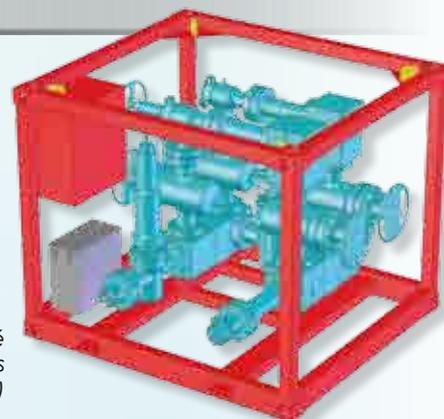
Manifold Intégré pour tests de puits (avec ESDV et data header)
