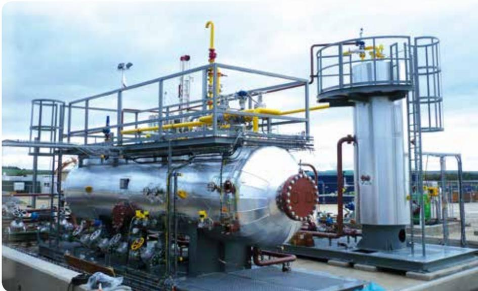
Séparateur de production 1500 x 6000 x 10 bar avec un dégazeur vertical 1200 x 3124 x 10 bar
